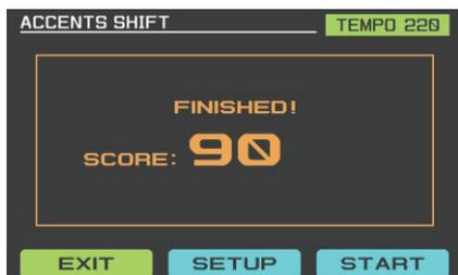
3. SET UP をクリックして設定画面に入ります。▲もしくは▼キーを押して設定したい機能を選び、INSTRUMENT ノブで、パラメーターを調整します。
