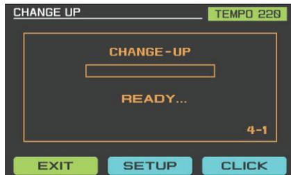
2. このモードにはスコアがありません。SET UP をクリックして設定画面に入ります。▲もしくは▼キーを押して設定したい機能を選び、INSTRUMENT ノブで、パラメーターを調整します。
