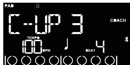
3. C-UP1 のモードで、MENU を押して CHANGE UP の設定に入ります。ENTER ボタンで設定したパラメーターを選択します。選択されたパラメーターが点灯し、+ ボタンでその値を調整します。(BAR= 小節数、テンポチェンジ後の小節数、BPM = 練習速度)
