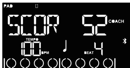
3. TIME1 が表示されている状態で、MENU をクリックしてタイムチェックの設定に入ります。ENTER ボタンを押して調整したパラメーターを決定します。設定したい値が点滅して、+ ボタンでその値を調整します。(SCOR = オープン/クローズスコア、TIME = 練習時間、BPM = 練習速度)
