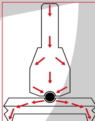
音叉の原理による微振動の集中と拡散
