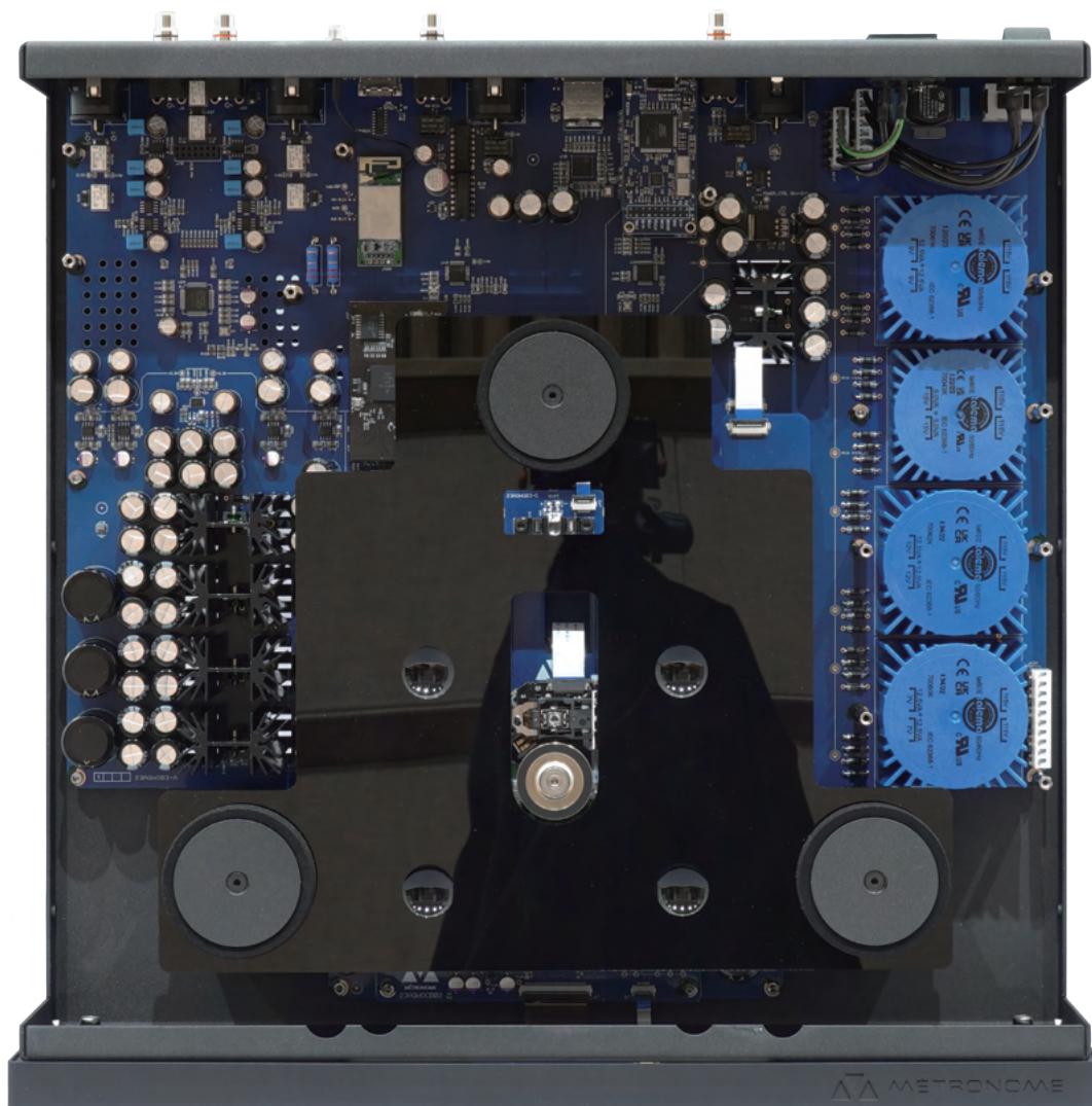
小容量キャパシターを並列で数十個使用しチョークコイルを組み合わせた低インピーダンスでローノイズ電源回路
