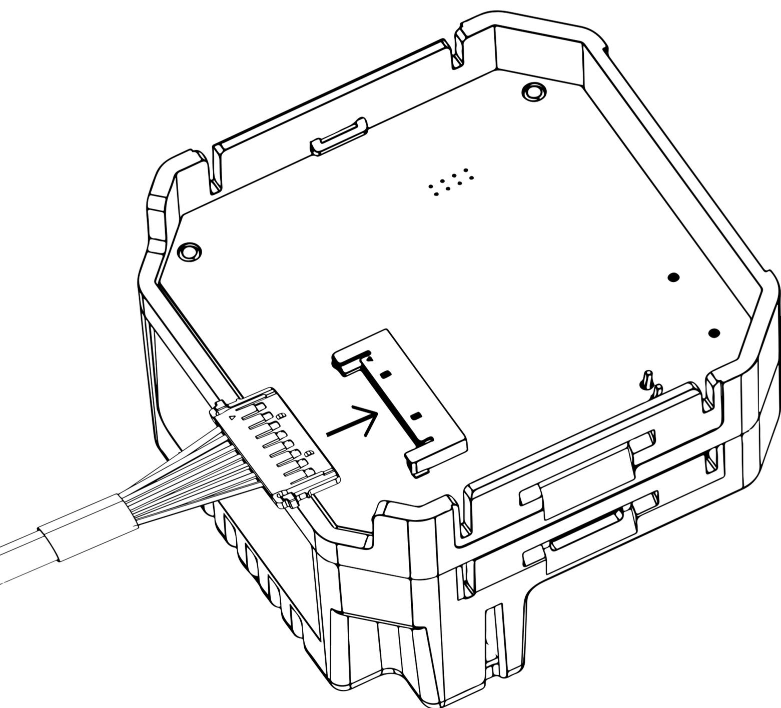
5. 本製品を WallStation の背面に取り付け、LANケーブルを本製品のRJ-45ポートとPoE+スイッチまたはPoE+ Injector (別売)に接続し、対象のiPadへ適切に給電と有線LAN接続が提供できているか確認します。
