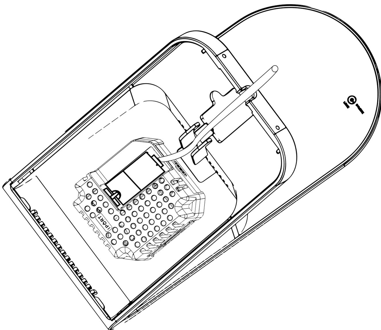
**10. LANケーブルを配線溝に這わせた後、先ほど取り外した配線カバーを取り付けます。**
