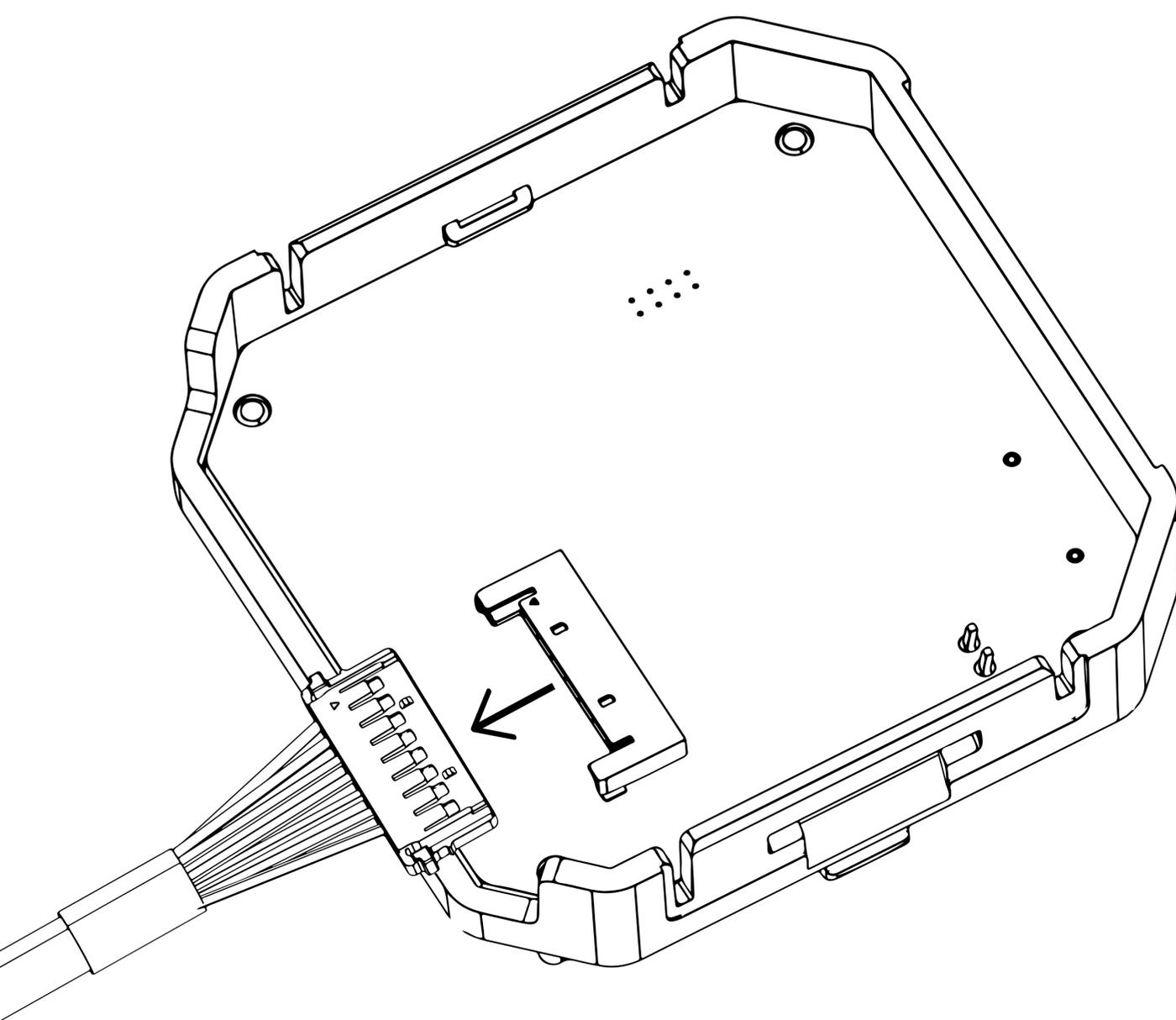
4. WallStationから取り外した配線を本製品に注意深く挿入します。
