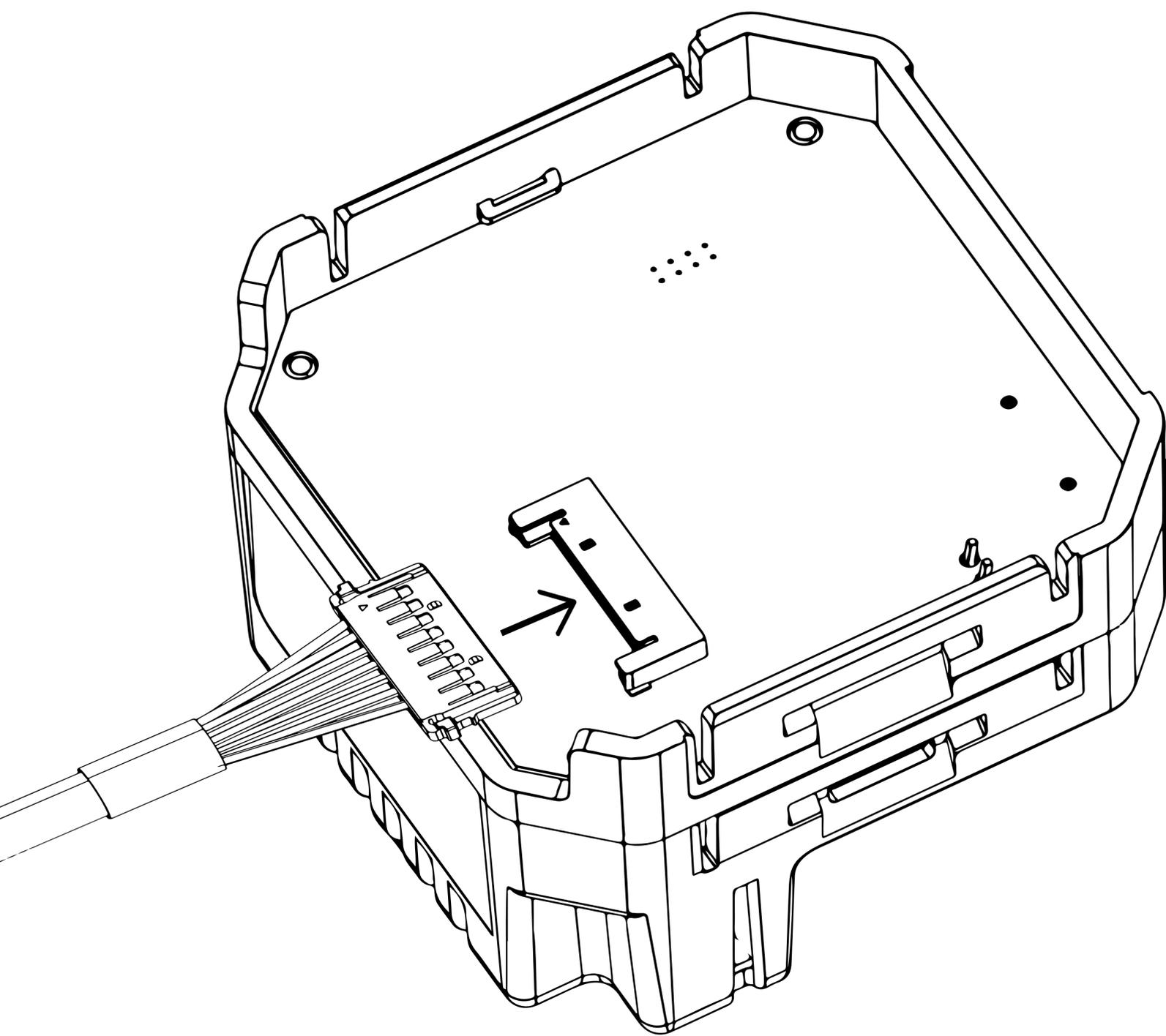
8. 本製品をBaseStationに取り付ける前に、LANケーブルを本製品のRJ-45ポートに挿入します。
