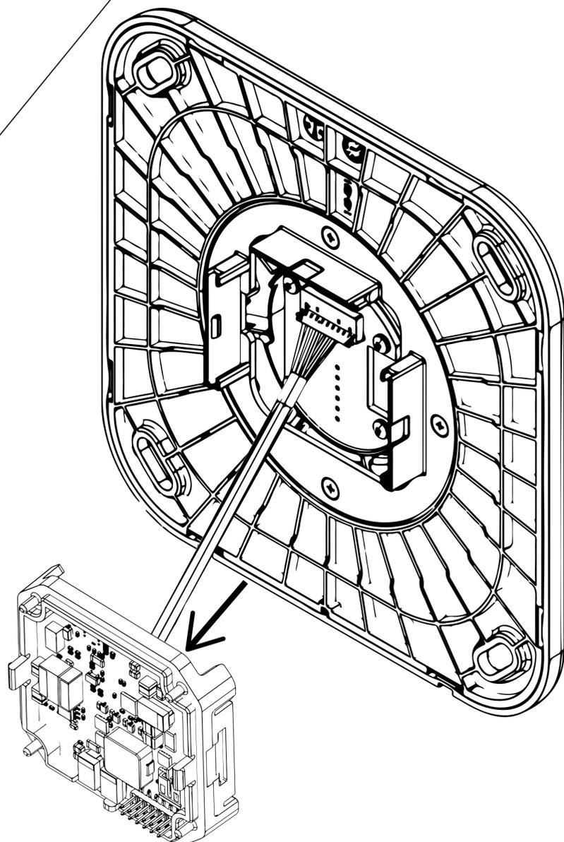
3. DC ボードを裏返し、接続されているケーブルを露出させ、DC ボードから注意深く取り外し、DC ボードを脇に置きます。
