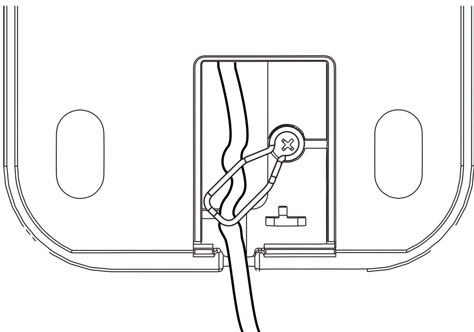
**12. 取り外したBaseStationを底部に取付け、セキュリティーツールで時計回りに回転させてネジを締めます。**
