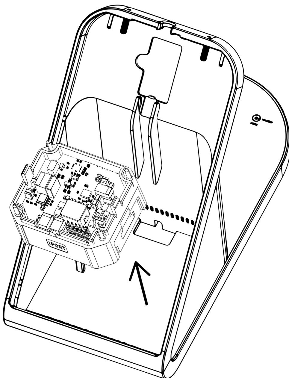
**6. DC ボードから配線を注意深く抜き、DC ボードを取り外します。**
