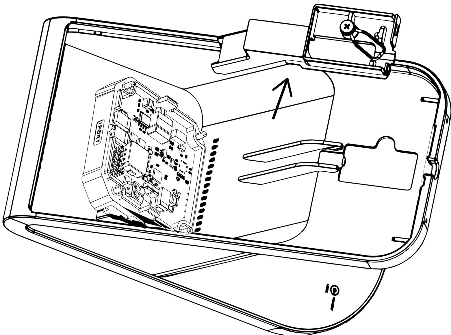
5. DC ボードを BaseStation から持ち上げて裏返し、接続ケーブルを露出させます。
