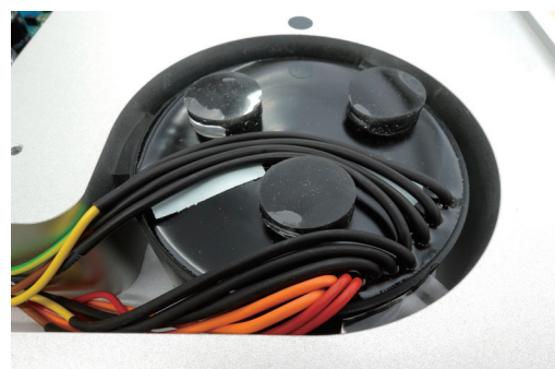
削り出し筐体 / 電源トランス
