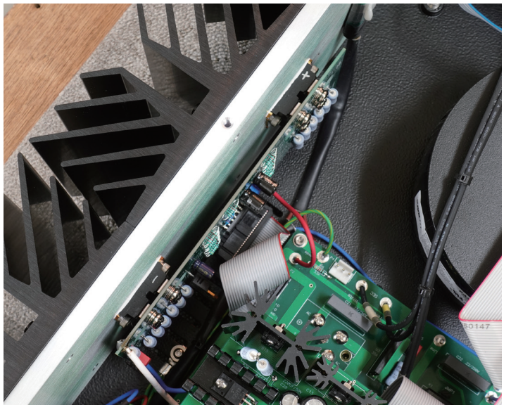
700ワット / 40アンペアの能力を有する産業用パワーMOSFETによるシングルプッシュプル構成の出力段。
