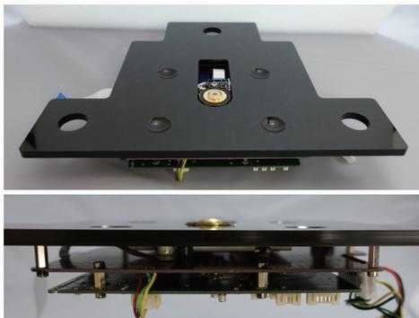
アクリルプレートに吊り下げてマウントされたドライブメカニズム
