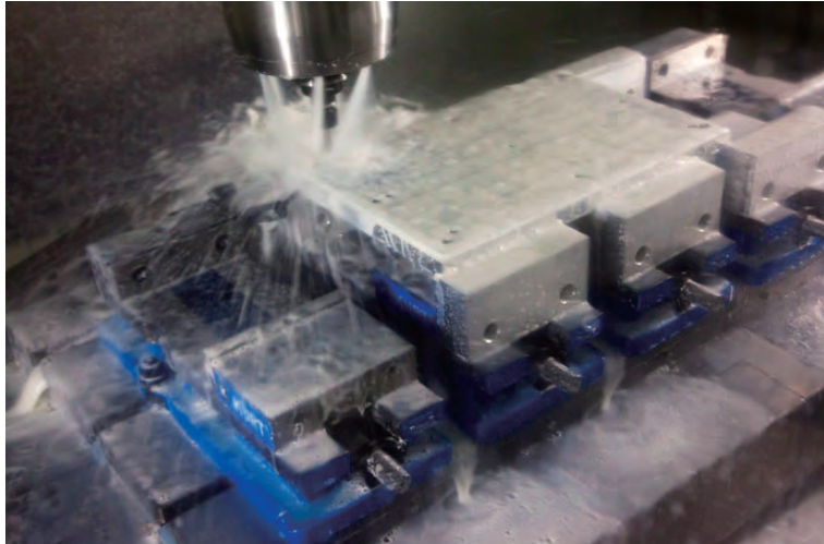
完全なクオリティコントロールでキャビネット等すべての切削加工を行なうための CNC 加工工場、すべての Q/S シリーズスピーカーキャビネットに使用されている 6061 系アルミニウム合金を最新の CNC マシンで精密切削しています
