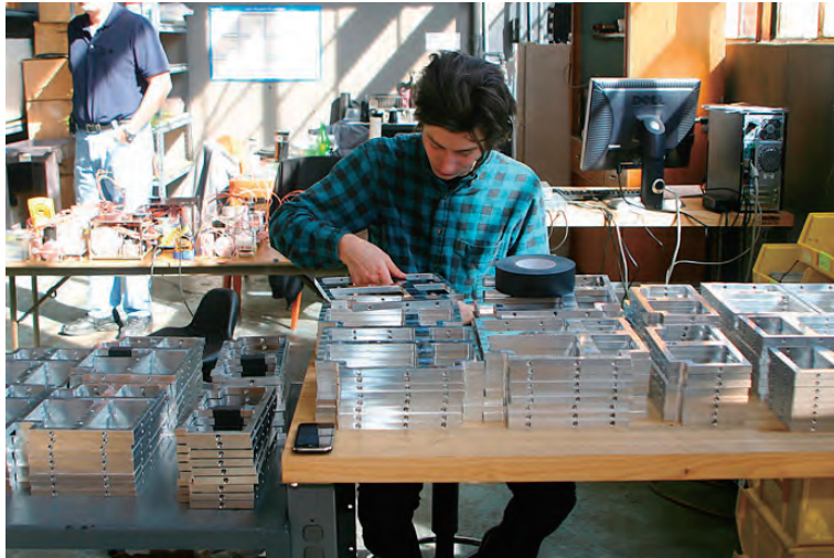
ドライバー / バッフル装着前の Q エンクロージャ、精密切削加工されたアルミニウムアパーツ
