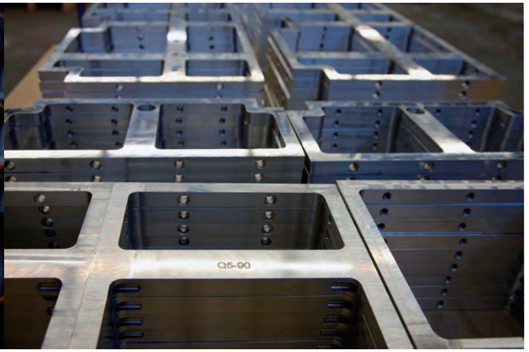
ドライバー / バッフル装着前の Q エンクロージャ、精密切削加工されたアルミニウムアパーツ
