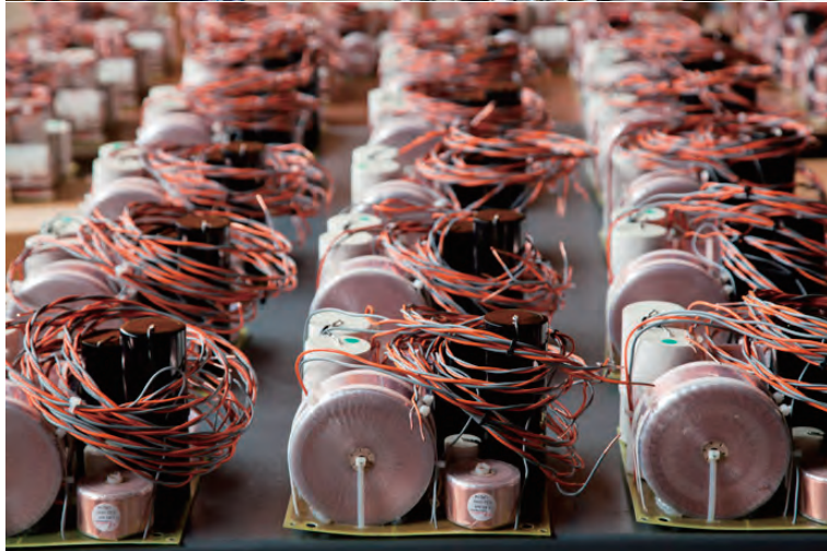
何百ものスクリューが Q シリーズでは使用されています。これらは永久的に緩まないロックタイト接着され、不用意に共振することはありません、内部配線と内部骨組みとの絶縁加工工程、ドイツ Mundorf の最高品質クロスオーバーパーツ
