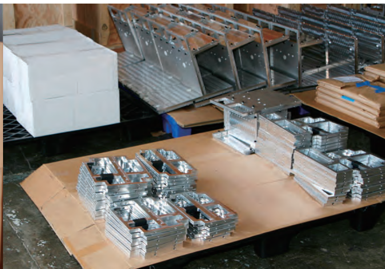
キャビネット素材のアルミニウム合金パーツ群
