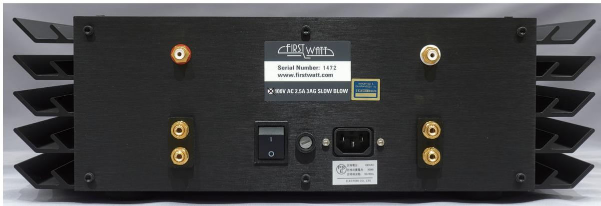
SIT-4 は、ファーストワットが生産した最新のアンプであり、静電誘導トランジスタ (SIT) をパワーアンプ増幅素子として使用する 4 番目のアンプです。2011 年に、セミサウス社製 (SemiSouth) のカスタムシリコンカーバイド (SiC) トランジスタを使用した最初の SIT アンプ "SIT-1" を設計しました。このアンプは、フィードバックなしでシングルエンド純 A “コモンソース” モードで動作する単一のパワーデバイスを使用して、トライオードの特性を模倣しつつ、スピーカーに直接必要な電圧と電流で動作し、出力トランスを排除して 10 ワットの電力を提供しました。
