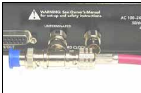
図2: Rosetta 800 WC 入力に接続されている "T" 及び プラグ
