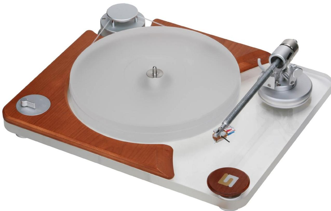
UNISONの管球アンプシリーズ、UNICOシリーズにマッチするアナログターンテーブル、Giro（ジロ）の登場です。高精度切削加工の亚克力プラッターをシリコンベルト /DC シンクロナスマーターでコントロール、33 1/3 /45 スイッチ切替のベルトドライブモデルです。三層のチェリー無垢材と亚克力ベースをサンドイッチして、レゾナンスをコントロール、UNISON オリジナルのソフトフロートサスペンションにより、カートリッジからクリアな音質を引き出します。また、カーボンストレートアームは、強固なアームベースとステンレスメインウェイトでユニゾンならではのアレンジが施されています。
