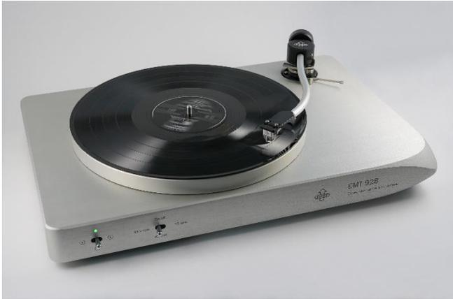
EMT 928 IIは、総重量23kgの重厚且つ精密設計を追求したターンテーブルです。シャーシはアルミニウムから削り出され、外部からの振動を効果的に抑制する4つのデカップリングされた球状の特製インシュレーターで支持されます。軟質性の素材を筐体脚部内に使用し筐体内への振動の伝播を遮断するフローティング構造を取り入れてます。プラッターの回転数は3段階（33 1/3、45、78rpm）で、あらゆる種類のレコードの再生に対応しています。現在発売中のEMT 9インチ・トーンアーム、およびすべてのEMTカートリッジと完璧にマッチングします。
