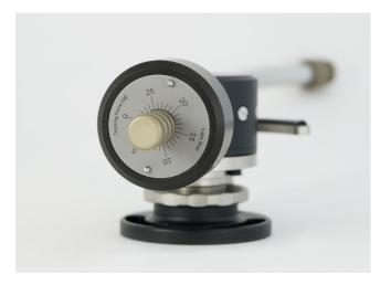
マグネット式アンチスケーティング機構と VTA調整用リングを搭載しています。トーンアームリフターは製品に付属しており、トーンアームリフターを備えたEMTターンテーブルで使用する場合は取り外すことが可能です。最新の知見に基づきトラッキングのジオメトリーを最適化しましたが、トーンアームのすべてのマウント特性は変更されていません。
